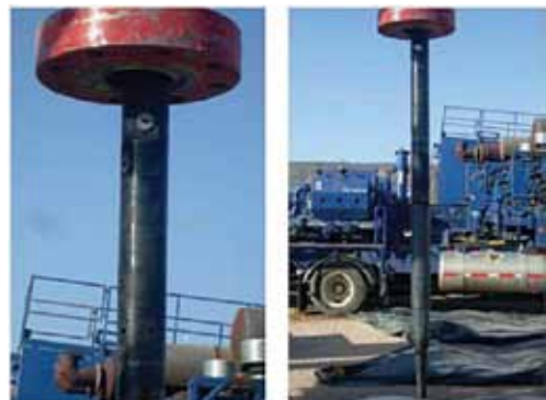
Figura 7. Jet de punzado entrando en los lubricadores 4 1/16" 10kpsi (izquierda); jet de punzado con Setting Tool hidráulico.
