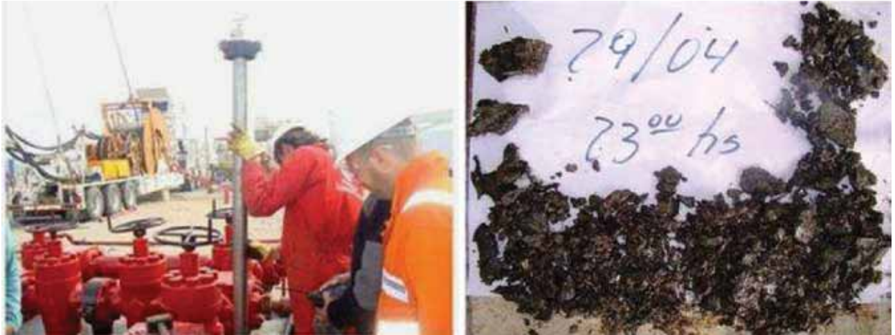
Figura 12 (izquierda). Dispositivo Debris Catcher utilizado en la operación de rotado; (derecha) recortes de los tapones extraídos durante la operación.
