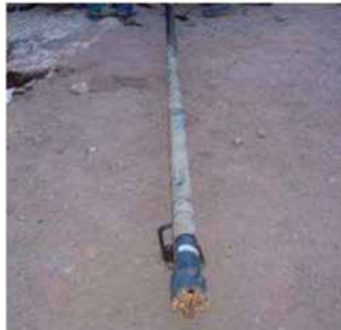
Figura 11. BHA de rotación utilizado en la operación.
