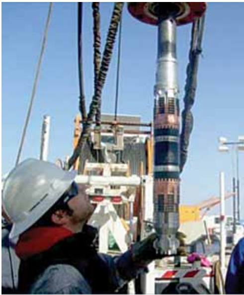
Figura 8. Tapón de 5" 18 lb/ft con Adapter Kit montado en el Setting Tool.
